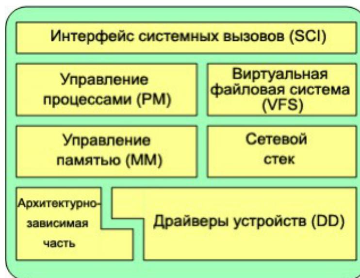
Рис. 12. Архитектура ядра Linux
