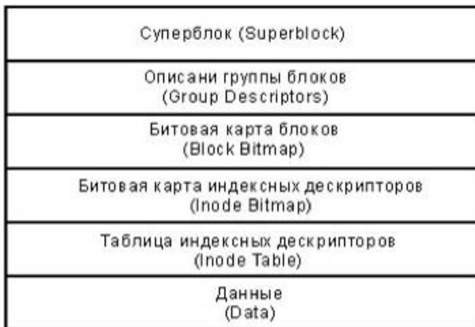
Рис. 16. Обобщенная структурная схема файловой системы ext2
