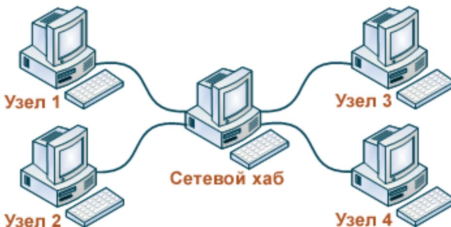
Рис.1. Топология типа «звезда»
